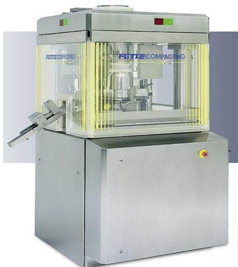
Figure 13 : La compresseuse FETTE i1200.
